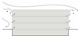
Querlüftung bei natürlicher Lüftung
